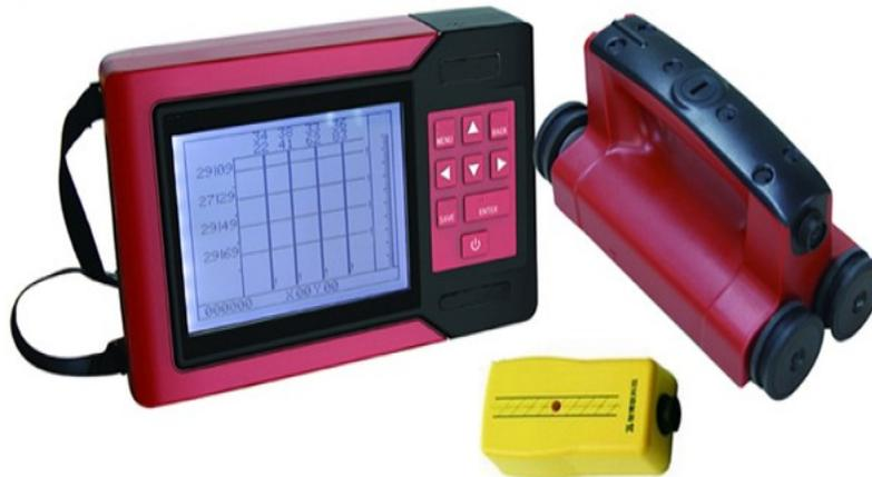
Il pacometro ZBL-R630A si utilizza per rilevare la posizione delle barre nel cemento, lo spessore degli strati protettivi e il diametro, l'orientamento e la distribuzione delle barre attraverso il metodo dell'induzione elettromagnetica. Può anche essere utilizzato per rilevare la distribuzione di magneti e conduttori come tubi metallici in un mezzo non magnetico e non conduttore.
