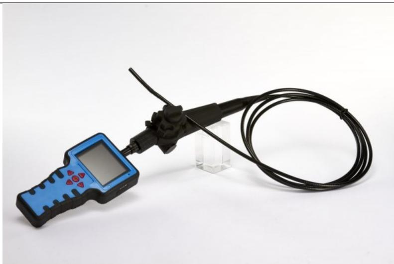
EV88-DS3 è un videoendoscopio compatto dotato di cavo sonda flessibile di diametro ridotto con rotazione a 4 vie, in grado di registrare video e foto su memoria SD rimovibile. Lo strumento è inoltre dotato di sorgente luminosa a led e schermo TFT a colori per la visualizzazione delle immagini e dei video. Tramite il display integrato ed i tasti funzione è possibile effettuare il settaggio dello strumento in maniera facile ed immediata.
