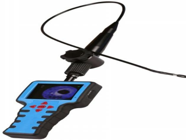
EV88-DR3 è un videoendoscopio compatto dotato di cavo sonda flessibile di diametro ridotto con rotazione a 2 vie, in grado di registrare video e foto su memoria SD rimovibile. Lo strumento è inoltre dotato di sorgente luminosa a led e schermo TFT a colori per la visualizzazione delle immagini e dei video. Tramite il display integrato ed i tasti funzione è possibile effettuare il settaggio dello strumento in maniera facile ed immediata.
