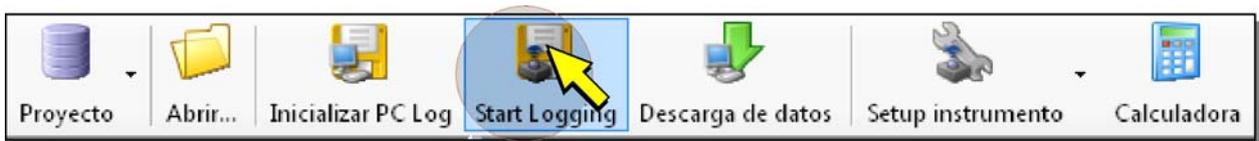
Después de haber inicializado el registro, el icono *Start Logging* va a ser remplazada por el icono *Stop Logging*. Para parar manualmente el registro, seleccionar el icono *Stop Logging* (o, alternativamente, pulsando para 5 segundos la tecla en la parte trasera del instrumento). Los datos van a ser guardados en la carpeta Logging dentro de la carpeta predefinida; el archivo se puede identificar según los momentos de inicialización y parada del logging.
