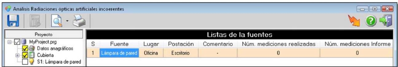
El panel derecho contiene dos columnas adicionales: *Núm. mediciones realizadas* (número de mediciones realizadas sobre la fuente) y *Núm. mediciones Informe* (número de mediciones utilizadas para preparar el informe de evaluación). El contenido de las columnas es cero por ahora y será actualizado más tarde, cuando a la fuente se asociarán unas medidas.
